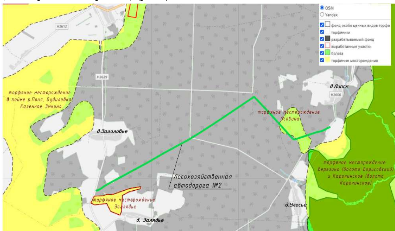
Рисунок 3. – Схема расположения торфяников в районе строительства
